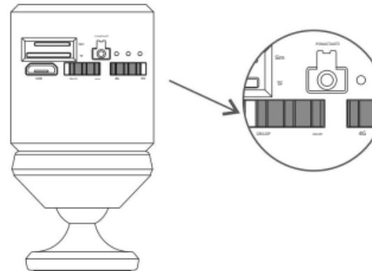
Obrnite stikalo za vklop na "ON", gumb za preklop načina na "DV" in vstavite kartico TF za 24 ur neprekinjenega snemanja.
